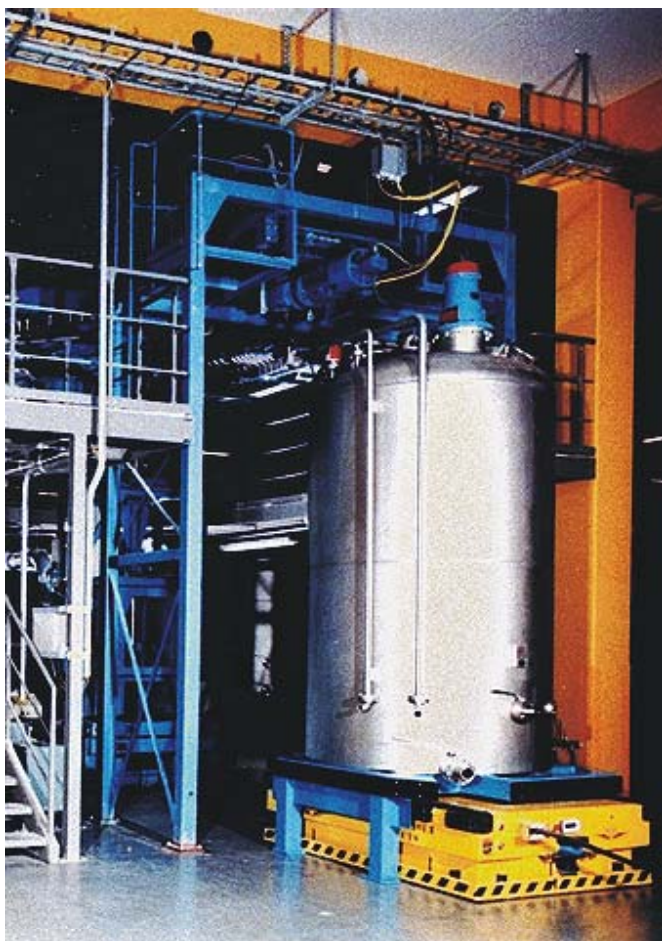
Foto 1: un contenedor de mezcla se transporta sobre cojines neumáticos a la instalación dosificadora.
