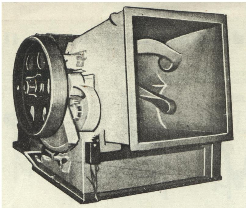
Diseñada y construida para procesos de mezclado y amasado de pastas y polvos húmedos. Su robustez la hace especialmente apta para la producción a escala de laboratorio o industrial, de masas pesadas del tipo de las empleadas por la industria farmacéutica, jabonera, del plástico, del caucho, de la alimentación; en la fabricación de adhesivos, placas de acumuladores, asfaltos, cementos y en todo proceso donde se mezclen o amasen productos similares.
